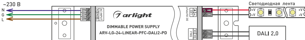
Рис. 1. Подключение источника питания при использовании интерфейса DALI 2.0
