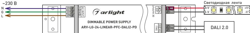
Рис. 1. Подключение источника питания при использовании интерфейса DALI 2.0
